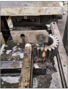
图7 电火花线切割 Fig. 7 EDM wire cutting
