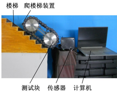
图 11 梯级式爬楼梯装置试验实物图
