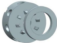
图3 轮坯铣齿几何模型
