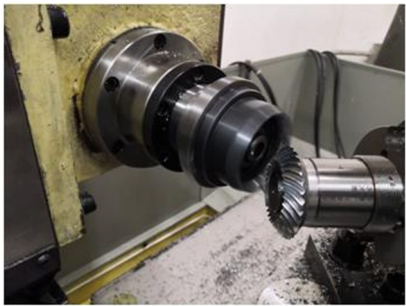
图 8 干式切齿过程 Fig. 8 Dry cutting process
