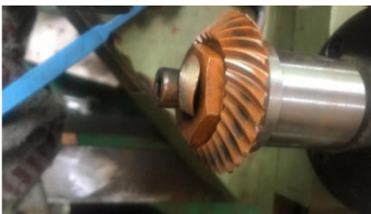
图 9 齿轮滚动检查 Fig. 9 Gear rolling inspection
