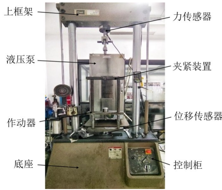
图 14 MTS-850.25型减振器专用试验台结构示意图
