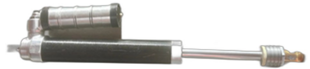
图13 单筒双活塞阻尼可调减振器实物图
