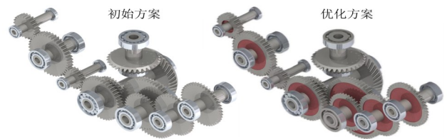
(a) 初始和优化的齿轮传动系统结构对比
