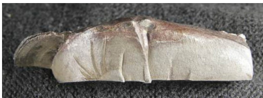
图3 断齿的宏观形貌
